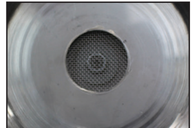
La pantalla de seguridad en la tapa evita que los gránulos de resina destruyan el motor si se produce un daño en el filtro
